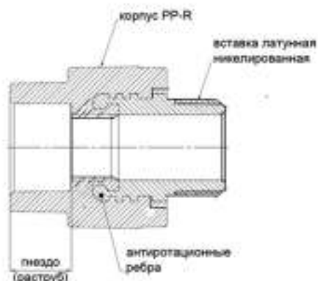
Рис.1 - Конструкции комбинированного фитинга
